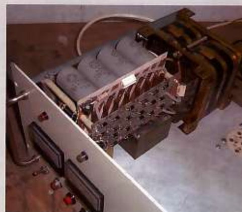
Opstelling condensatorblok, trafo's en diodeprint.
